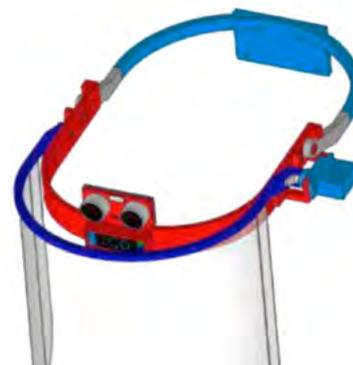
Figura 3. Diseño de Careta automatizada en SolidWorks.
