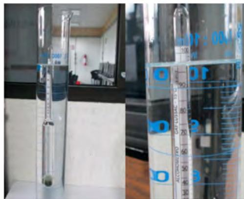
Figura. 6. Comprobación de la concentración del alcohol .
