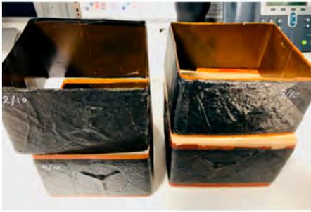
Figura 10. Geometría de Resina Epoxi/Fibra de Carbono Adaptada por Mandril.
