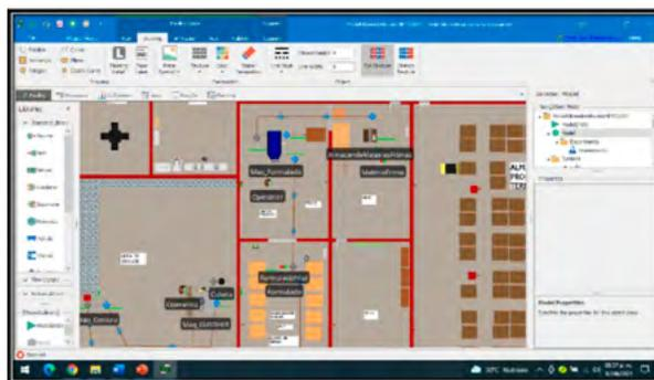
Figura 6. Redistribución de Planta derivada de la aplicación del SLP
