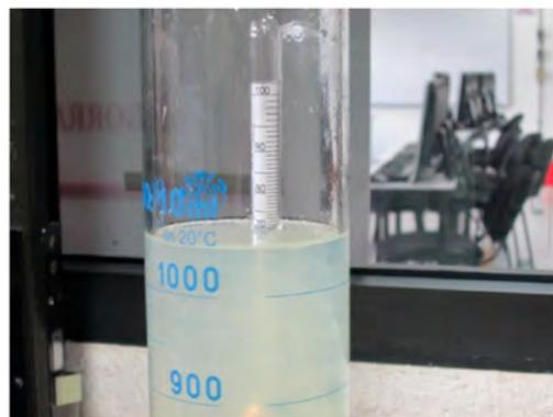
Figura. 7. Comprobación de la concentración (70° G.L.) del sanitizante .
