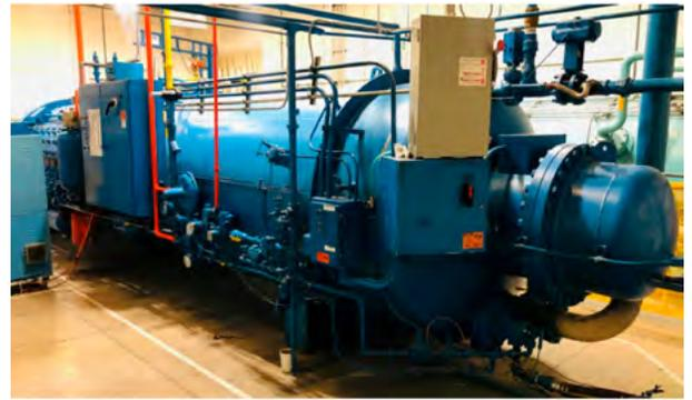
Figura 8. Autoclave para Tratamiento Térmico.
