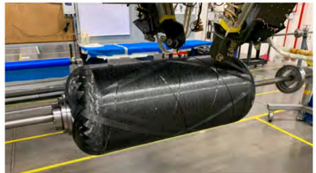
Figura 1. Tanque de Material Compuesto en Sistema de Entrega de Fibra.
