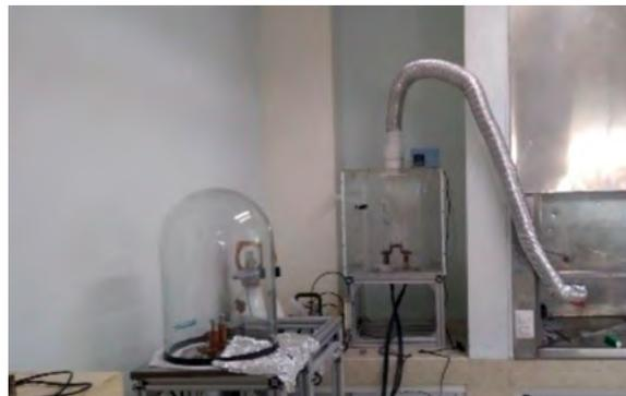
Imagen 1. Equipo para depositar recubrimientos.
