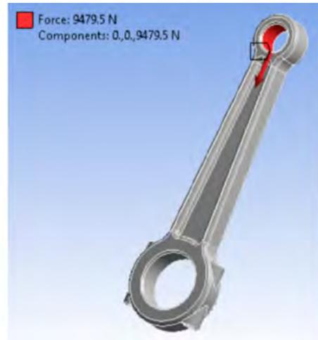
Figura 3. Condiciones de frontera.
