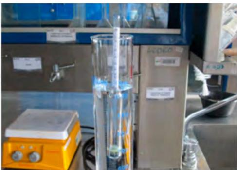
Figura. 5. Calibración del alcoholímetro a 0° con agua destilada.
