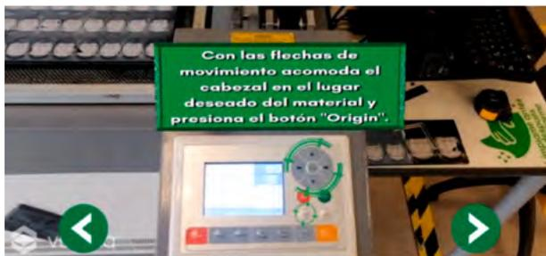
Figura 8. Posicionar el cabezal en el lugar de origen.
