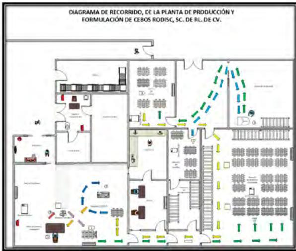
Figura 3. Croquis de la Planta RODICS con el diagrama de recorrido del proceso productivo
