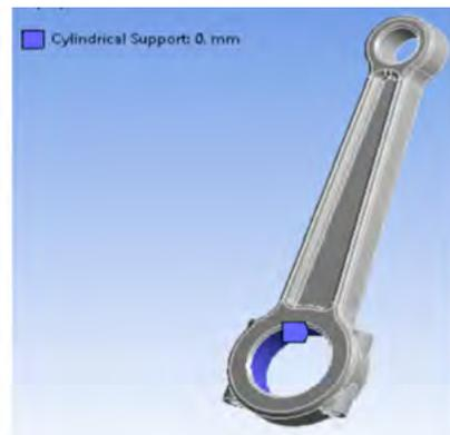
Figura 4. Soporte cilíndrico aplicado en la base de la cabeza.
